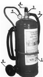
Рис. 6.4. Огнетушители порошковые ОП-50(з): корпус 1; шланг 2 с насадкой; запорно-пусковое устройство с сифонной трубкой 3; рукоятка 4; манометр 5; колеса 6
